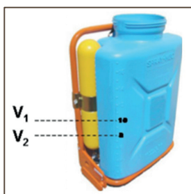
Figura 2. Marcaje del volumen final ( V_2 ) para calibración del equipo. Fuente: ICAFE, 2009.
