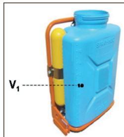
Figura 1. Marcaje del volumen inicial ( V_1 ) para calibración del equipo. Fuente: ICAFE, 2009.
