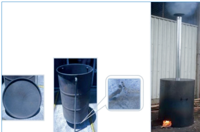
Figura 2. Horno de producción de biocarbón o carbonizador portátil de doble estañón del TEC.
