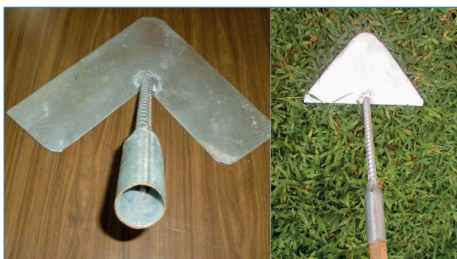
Figura 1. Flecha deshierbadora. Fuente: Chávez, 2014.
