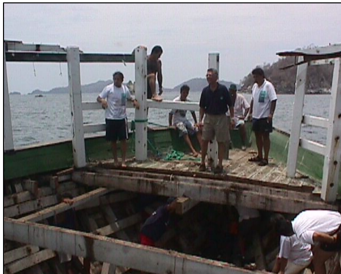
Figura 4. La Paquereña, embarcación de madera al momento del lastrado utilizando rocas para mantenerlo en el fondo. Cortesía J. Campos.
