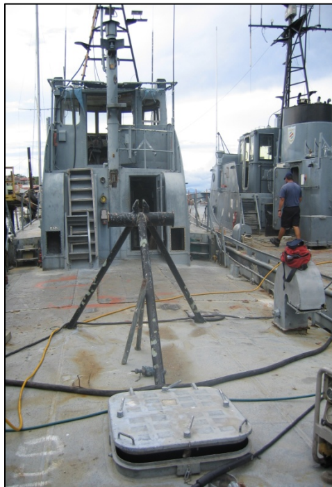
Figura 3. Preparación de las embarcaciones guardacostas “coronel Alfonso Monge” en primer plano y “Franklin Chang” para su hundimiento. Las escotillas y torres para antenas y otros equipos se removieron, y el proceso de limpieza tardó más de seis meses. Cortesía de J. Campos.
