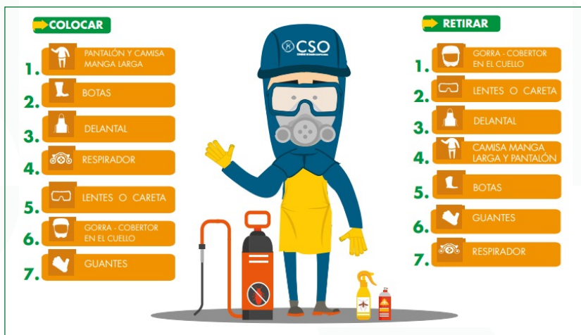
Figura 26. Equipo de Protección Personal (EPP) según el consejo Salud Ocupacional de Costa Rica
